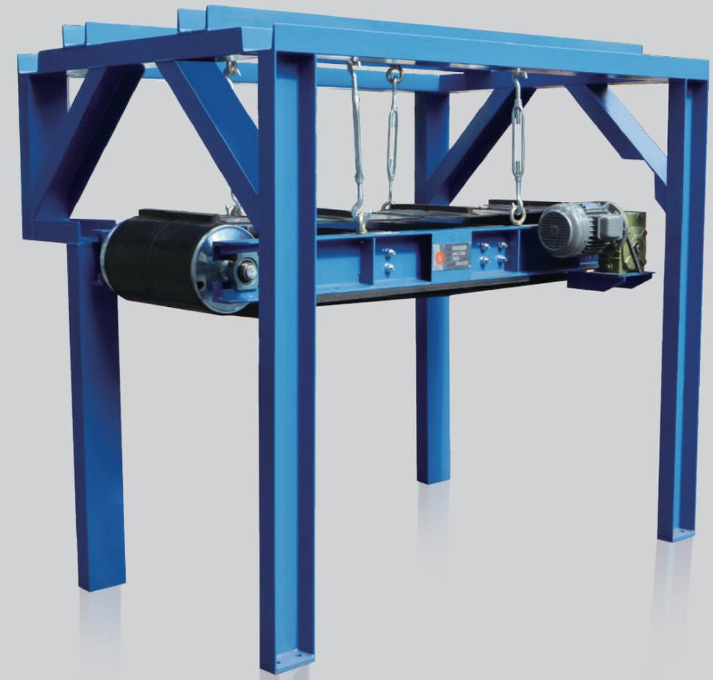
適用於建築、爐渣、砂石、鋼鐵、煤炭、木材、棧板回收等產業，能有效排除原料中的含鐵物質
